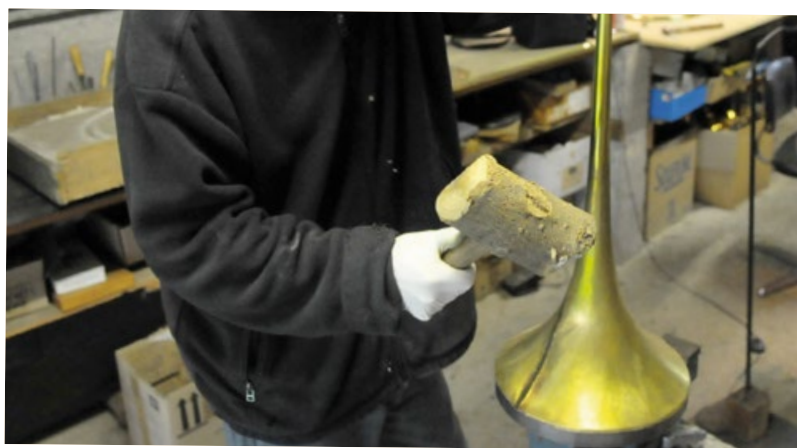
Le pavillon est fabriqué à part d'une tôle de 0,3 mm d'épaisseur. Il est d'abord martelé à chaud avec un maillet en bois pour lui donner une rondeur parfaite.
