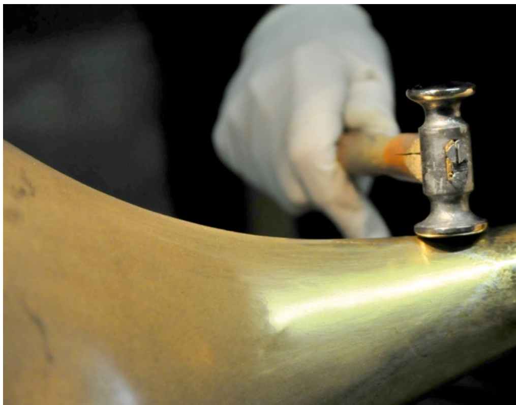
Deuxième étape, le martelage à froid avec un outil en acier. Au final, 80 000 coups de marteau sont nécessaires à la fabrication d'une trompe.
